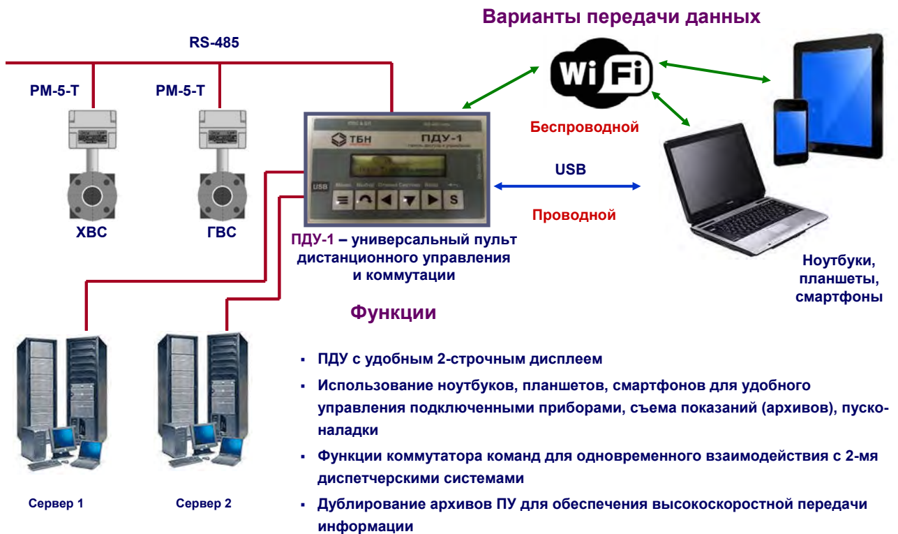
Рисунок 2 — Использование панели ПДУ-1 для управления РМ-5-Т
